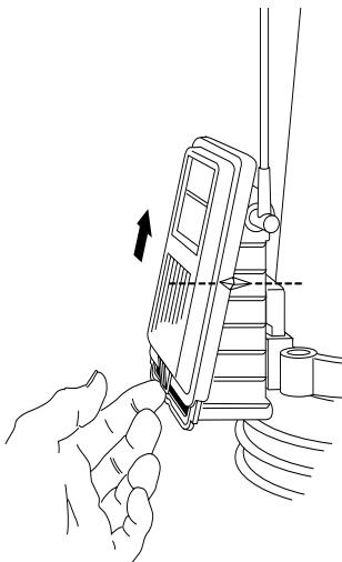
*Faites coulisser le couvercle vers le haut jusqu'à ce que les marques sur le côté soient alignées.*
