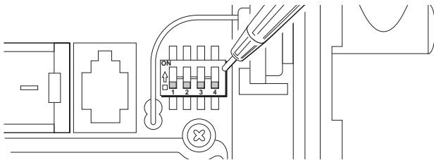
*Micro-interrupteurs de l'ID d'émetteur dans le coin supérieur droit du SIM*
