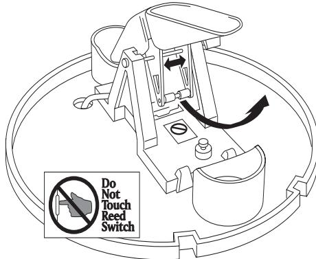
*Ouvrir le bras du mécanisme de basculement en plastique,
