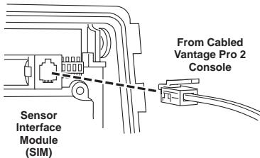
3. Insérez l'extrémité du câble de la console dans l'orifice de branchement depuis l'arrière du boîtier SIM.
